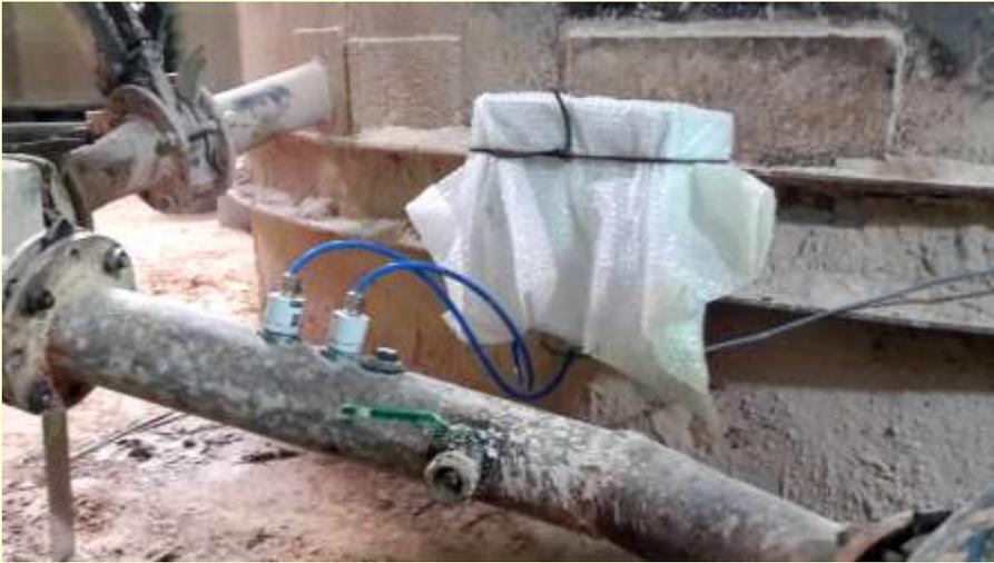
**Работа плотнoмера на Минском комбинате силикатных изделий.**
