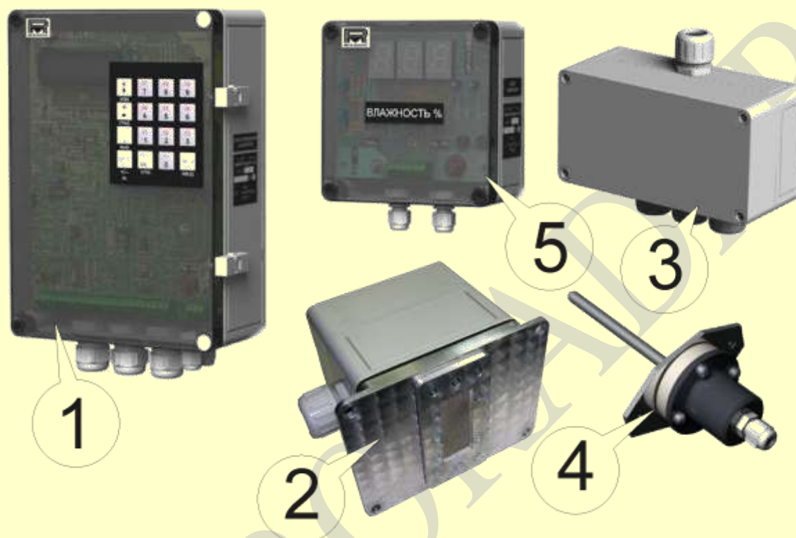
Рис. 1.1. Влагомер «MP-113S20». Общий вид
