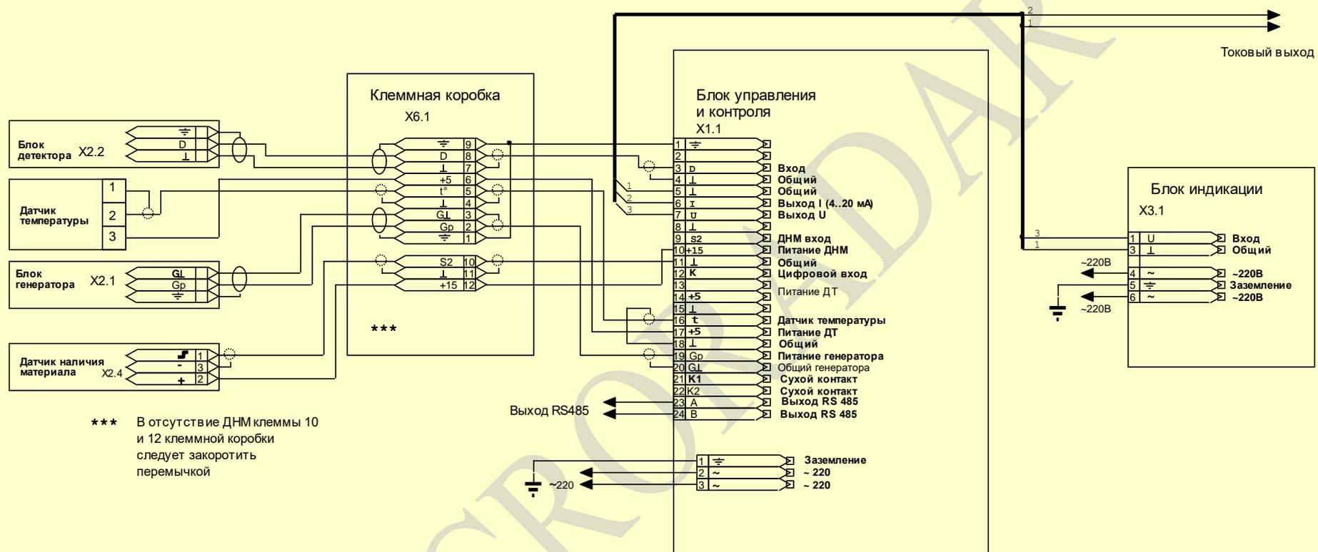
\*\*\* В отсутствие ДНМ клеммы 10 и 12 клеммной коробки следует закортить перемычкой
