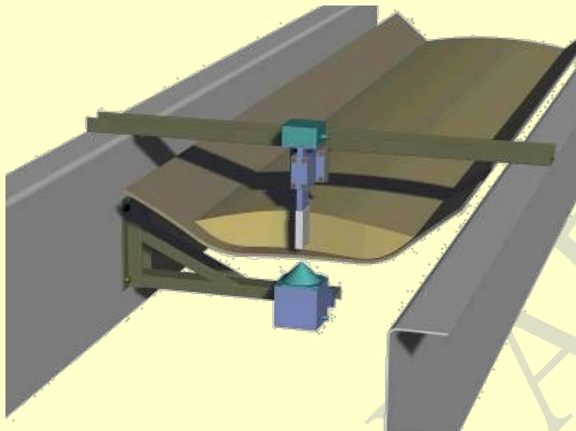
Рис. 2. Размещение блока сенсоров в технологическом потоке
