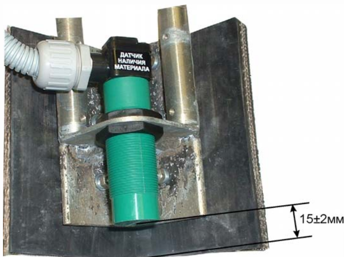
Рис. 7.2. Монтаж ДНМ на формирователе слоя
