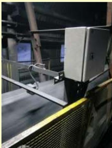
Бесконтактный микроволновой амплитудно-фазовый влагомер двухстороннего типа **МИКРОРАДАР112К13К** предназначен для измерения влажности сыпучих материалов с классами от 0 до 150 мм и толщиной 50-300 мм. на конвейерных лентах. Влагомер может функционировать совместно с конвейерными весами, комплектоваться ультразвуковым уровнемером, измеряющим толщину слоя материала или формирователем толщины слоя.
