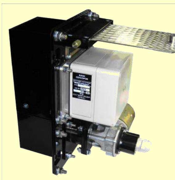
Датчик крепится на стенке бункера или самотека в подготовленном отверстии таким образом, чтобы падающее зерно попадало в наполнительный короб. Верхняя часть короба оборудована задвижкой, при помощи которой перекрывается доступ зерна в измерительное пространство при диагностике и обслуживании датчика.
