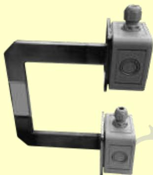
Принцип действия влагомеров основан на измерении величины поглощения СВЧ энергии влажным материалом и преобразовании этой величины в цифровой код, соответствующий влажности материала. Чрезвычайно высокая контрастность метода ( 1 см воды уменьшает мощность прошедшей радиоволны в 10000 раз ) позволяет измерять влажность как плотного зерна с высокой
